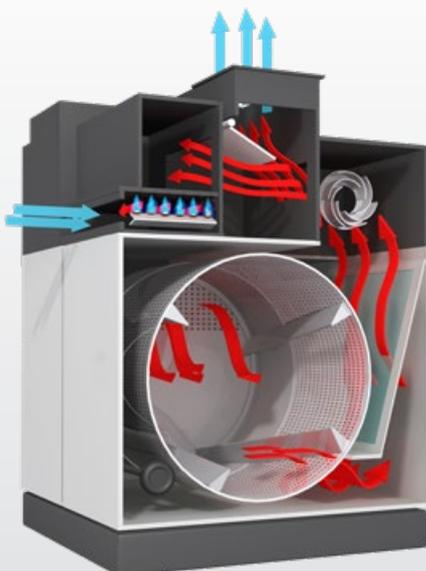
flux d'air avec recirculation pour ST2700/G
