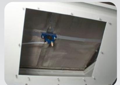
Le système d'auto-nettoyage du filtre a été conçu pour garantir le plus haut rendement du sècheur.
