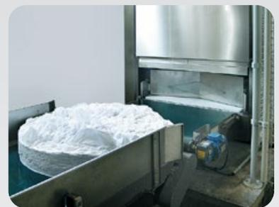
La presse d'extraction SPR-50 prépare le linge en provenance du tunnel de lavage pour son séchage ou repassage ultérieur.
