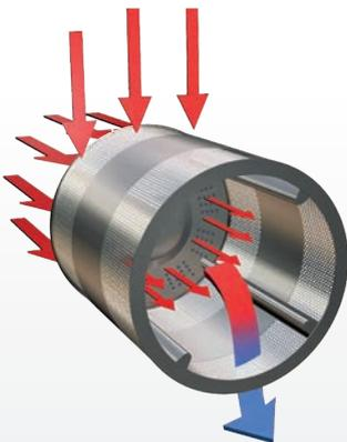
Diriger le flux d'air à travers le linge et utiliser au maximum sa température est une des clés pour obtenir le meilleur rendement d'un séchoir.
