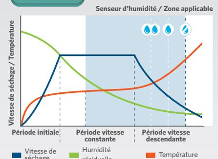
Le système de contrôle de l'humidité résiduelle est hautement fiable et précis. Évite de trop sécher les pièces et réduit le temps de cycle.
